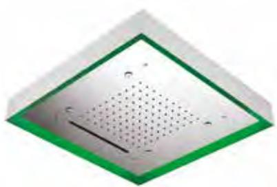
Soffione doccia a soffitto in acciaio inox 304L, quadrato 570 mm con ugelli anticalcare, dotato di getto pioggia, getto nebulizzato, getto cascata e cromoterapia a illuminazione LED, connessione G1/2".
