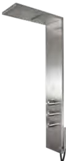
Colonna doccia termostatica a muro in acciaio inox 304L, con deviatore rotativo 2 vie, miscelatore termostatico con blocco temperatura, doccetta anticalcare con flessibile lungo 150 cm e connessione G1/2".
