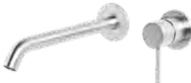
Miscelatore lavabo ad incasso, diametro di 34 mm, in acciaio inox 316L, con bocca lunga 12 cm, aeratore anticalcare M16,5x1 e connessione G1/2".
