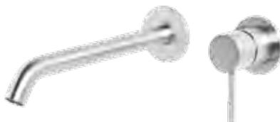
Miscelatore lavabo incasso con diametro di 34 mm, in acciaio inox 316L, con bocca lunga 20 cm, aeratore anticalcare M16,5x1 e connessione G1/2".
