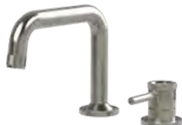
Miscelatore per lavabo 2 fori in acciaio inox 316L senza scarico, con bocca bassa, aeratore anticalcare M18, 5x1 e flessibili di collegamento G3/8" inclusi.
