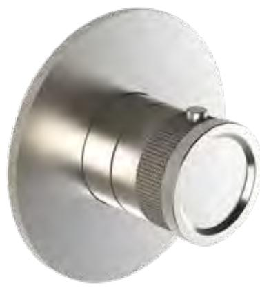
Miscelatore termostatico ad incasso 1 via in acciaio inox 316L, con valvoline antiritorno non ispezionabili e connessione G1/2".
