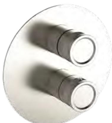
Miscelatore termostatico ad incasso 2 vie in acciaio inox 316L, con deviatore rotativo, valvoline antiritorno ispezionabili, connessione G1/2" e scatola ad incasso.
