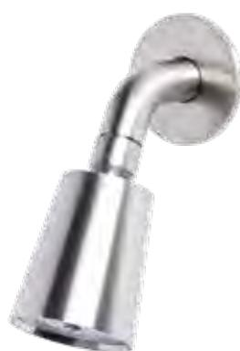
Soffione a muro orientabile a "campana" da diametro di 60 mm in acciaio inox 316L, getto pioggia libero (senza ugelli) e connessione G1/2".
