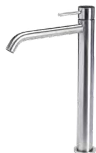
Miscelatore lavabo alto, diametro di 34 mm, in acciaio inox 316L, senza scarico, con bocca lunga 18 cm, aeratore anticalcare M16,5x1 flessibili di collegamento G3/8".
