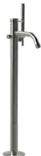
Miscelatore monocomando per vasca a pavimento in acciaio inox 316L, con deviatore a tiro con ritorno automatico, doccetta anticalcare con flessibile lungo 150 cm, bocca con aeratore anticalcare M24x1 e connessione G1/2".
