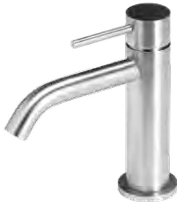
Miscelatore lavabo con diametro di 34 mm, in acciaio inox 316L, senza scarico, con bocca lunga 12 cm e aeratore anticalcare M16,5x1 flessibili di collegamento G3/8".
