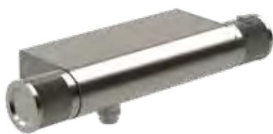
Miscelatore termostatico esterno per doccia in acciaio inox 316L, con blocco temperatura 38°, cartuccia con sistema anticalcare, valvoline antiritorno e connessione G1/2".
