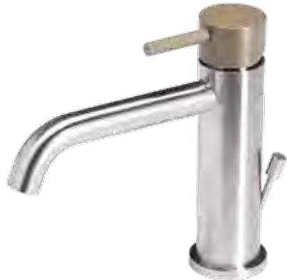
Miscelatore monocomando per lavabo con scarico da 1"1/4 e flessibili di alimentazione F3/8".
