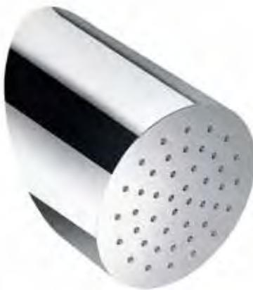
Soffione doccia a muro inclinato in acciaio inox 304L, tondo 155 mm con ugelli anticalcare, dotato di getto a pioggia e connessione G1/2".
