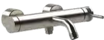
Miscelatore monocomando esterno alla vasca in acciaio inox 316L, con deviatore a tiro con ritorno automatico, bocca con aeratore anticalcare M18, 5x1 e connessione G1/2".
