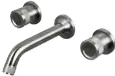
Miscelatore per lavabo ad incasso 3 fori in acciaio inox 316L, con bocca lunga 21 cm, aeratore anticalcare M18, 5x1 e vitone ceramico 1/4 giro e connessione G1/2".
