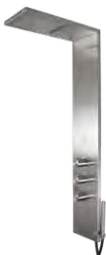
Colonna doccia a muro con miscelatore in acciaio inox 304L, con deviatore rotativo 2 vie, doccetta anticalcare con flessibile lungo 150 cm e connessione G1/2".
