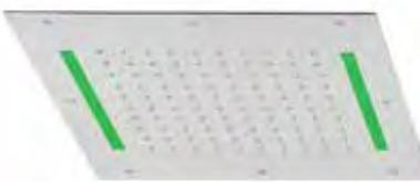
Soffione incasso doccia in acciaio inox 304L, quadrato 400 mm con ugelli anticalcare, dotato di getto a pioggia con cromoterapia a illuminazione LED, connessione G1/2", fissaggio con telaio e tiranti di sicurezza.
