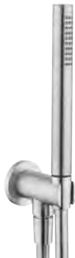
Set doccia in acciaio inox 316L con doccetta anticalcare con flessibile lungo 160 cm, presa d'acqua con supporto doccia con connessione G1/2" e rosone da diametro di 50 mm.
