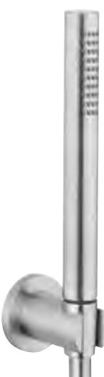
Set doccia in acciaio inox 316L, doccetta anticalcare con flessibile lunga 160 cm, presa d'acqua con connessione G1/2" e supporto doccia rosone da diametro di 52 mm.
