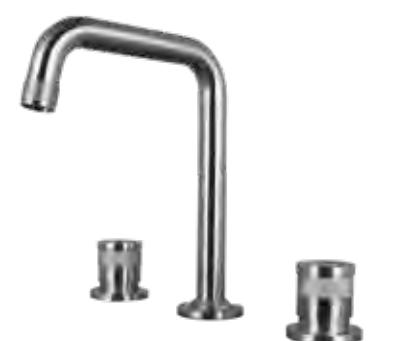
Miscelatore per lavabo 3 fori in acciaio inox 316L senza scarico, con bocca alta, aeratore anticalcare M18, 5x1 e vitone ceramico 1/4 giro e connessione G1/2".
