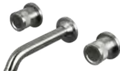
Miscelatore per lavabo ad incasso 3 fori in acciaio inox 316L, con bocca lunga 16 cm, aeratore anticalcare M18, 5x1 e vitone ceramico 1/4 giro e connessione G1/2".
