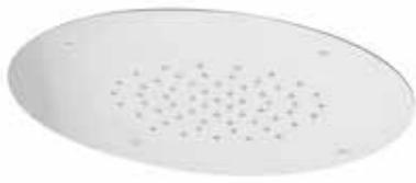
Soffione incasso doccia in acciaio inox 304L, tondo 300 mm con ugelli anticalcare, connessione G1/2" e fissaggio con telaio e tiranti di sicurezza.
