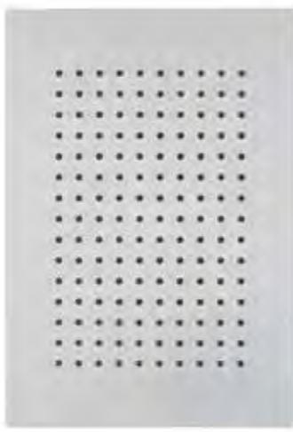
Soffione ad incasso per doccia in acciaio inox 316L, rettangolare 285x200 mm, con ugelli anticalcare, connessione G1/2" e fissaggio tramite agganci rapidi.
