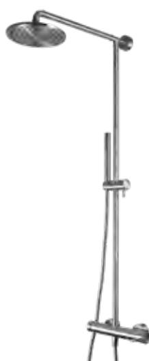
Colonna doccia monocomando con scorrevole in acciaio inox 316L, con deviatore a tiro con ritorno automatico, doccetta anticalcare con flessibile lungo 150 cm, connessione G1/2" e soffione ispezionabile da diametro di 20 cm.
