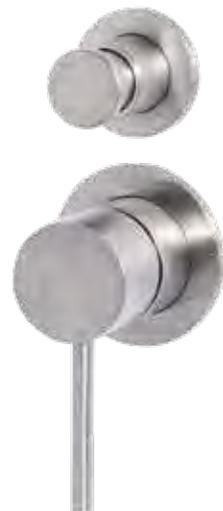
Miscelatore monocomando ad incasso 2 vie da diametro di 34 mm, in acciaio inox 316L, deviatore a pulsante con ritorno automatico e connessione G1/2".
