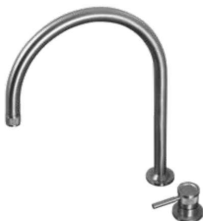
Miscelatore per lavabo 2 fori in acciaio inox 316L senza scarico, con bocca ad arco, aeratore anticalcare M18, 5x1 e flessibili di collegamento G3/8" inclusi.
