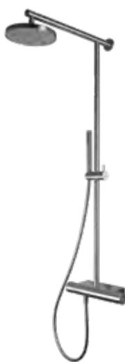
Colonna doccia termostatica con scorrevole in acciaio inox 304L, deviatore rotativo, doccetta anticalcare con flessibile lungo 160 cm, connessione G1/2", con valvoline antiritorno e soffione ispezionabile da diametro di 20 cm e alto 2 cm.
