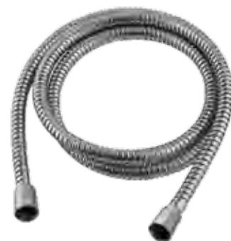
Flessibile doccia lungo 150 cm in acciaio inox 304L con attacco conico G1/2" e anti-torsione.
