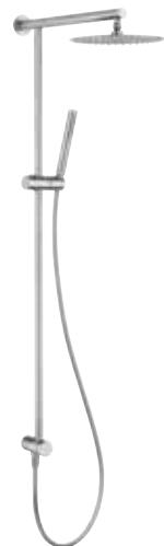
Colonna doccia con deviatore 2 vie in acciaio inox 304L, deviatore a tiro con ritorno automatico, doccetta anticalcare con flessibile lunga 160 cm, connessione G1/2", soffione ispezionabile da diametro di 20 cm.
