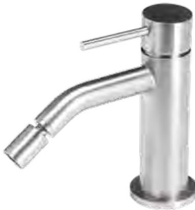
Miscelatore per bidet con diametro di 34 mm, in acciaio inox 316L senza scarico, con bocca con snodo, aeratore anticalcare M16,5x1 e flessibili di collegamento G3/8".
