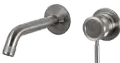
Miscelatore per lavabo ad incasso in acciaio inox 316L, bocca lunga 21 cm, aeratore anticalcare M18, 5x1 con Connessione G1/2".
