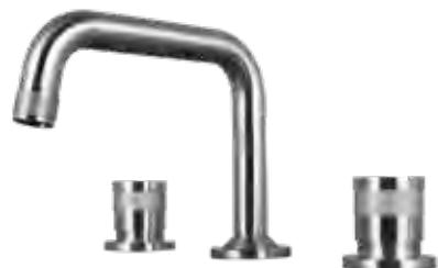
Miscelatore per lavabo 3 fori in acciaio inox 316L senza scarico, con bocca bassa, aeratore anticalcare M18, 5x1 e vitone ceramico 1/4 giro e connessione G1/2".
