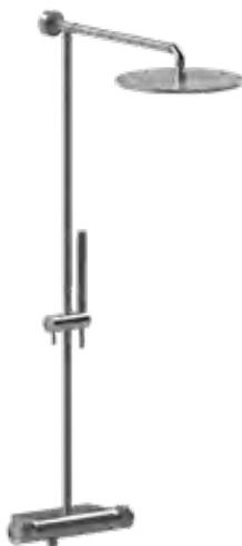
Colonna doccia termostatica con scorrevole in acciaio inox 316L, con deviatore rotativo, doccetta anticalcare con flessibile lungo 150 cm, connessione G1/2" con valvoline antiritorno e soffione ispezionabile da diametro di 30 cm.
