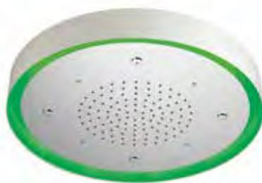
Soffione doccia a soffitto in acciaio inox 304L, tondo 570 mm con ugelli anticalcare, dotato di getto a pioggia, getto nebulizzato e cromoterapia a illuminazione LED, connessione G1/2".
