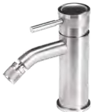
Miscelatore per bidet in acciaio inox 316L senza scarico, con bocca con snodo, aeratore anticalcare M16x1 e flessibili di collegamento G3/8" inclusi.
