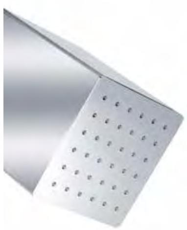
Soffione doccia a muro inclinato in acciaio inox 304L, quadrato 155 mm con ugelli anticalcare, dotato di getto a pioggia, connessione G1/2".
