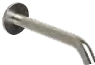
Bocca di erogazione a muro, diametro di 18 mm, lunga 15 cm, in acciaio inox 316L, con aeratore anticalcare M16x1 e connessione G1/2".
