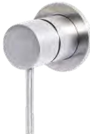
Miscelatore monocomando ad incasso con diametro di 34 mm, in acciaio inox 316L, con uscita in alto e connessione G1/2".
