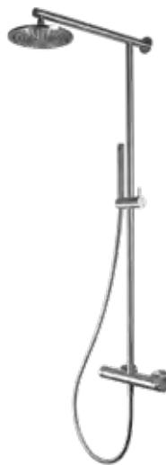
Colonna doccia monocomando con scorrevole in acciaio inox 316L, con deviatore a tiro con ritorno automatico, doccetta anticalcare con flessibile lungo 160 cm, connessione G1/2" e soffione ispezionabile da diametro di 20 cm.
