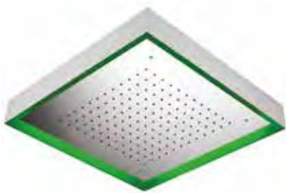
Soffione doccia a soffitto in acciaio inox 304L, quadrato 570 mm con ugelli anticalcare, dotato di getto a pioggia e cromoterapia a illuminazione LED e connessione G1/2".
