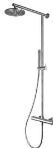
Colonna doccia termostatica con scorrevole in acciaio inox 316L, deviatore rotativo, doccetta anticalcare con flessibile lungo 160 cm, connessione G1/2" con valvoline antiritorno e soffione ispezionabile da diametro di 20 cm.
