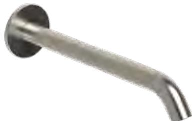
Bocca di erogazione a muro, diametro di 18 mm, lunga 20 cm, in acciaio inox 316L, aeratore anticalcare M16x1 e connessione G1/2".
