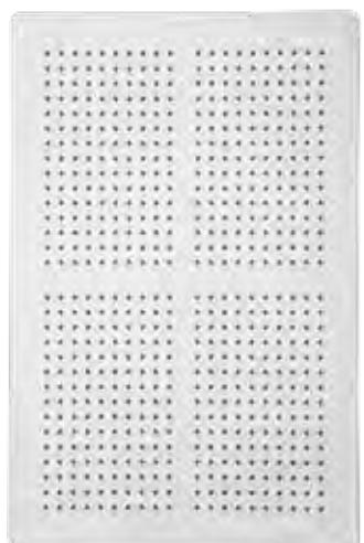
Soffione ad incasso per doccia in acciaio inox 316L, rettangolare 500x360 mm con ugelli anticalcare, connessione G1/2" e fissaggio tramite agganci rapidi.
