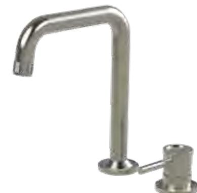
Miscelatore per lavabo 2 fori in acciaio inox 316L senza scarico, con bocca alta, aeratore anticalcare M18, 5x1 e flessibili di collegamento G3/8" inclusi.
