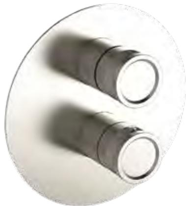
Miscelatore termostatico ad incasso 1 via in acciaio inox 316L, con deviatore rotativo, valvoline antiritorno ispezionabili, connessione G1/2" e scatola ad incasso.
