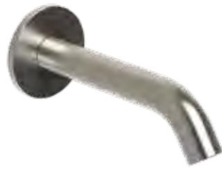
Bocca di erogazione a muro, diametro di 18 mm, lunga 12 cm, in acciaio inox 316L, aeratore anticalcare M16x1 e connessione G1/2".
