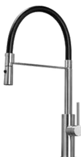
Miscelatore per cucina in acciaio inox 316L, con canna tonda flessibile rivestita in silicone, doccetta estraibile a 2 getti, anticalcare e flessibili di collegamento G3/8".
