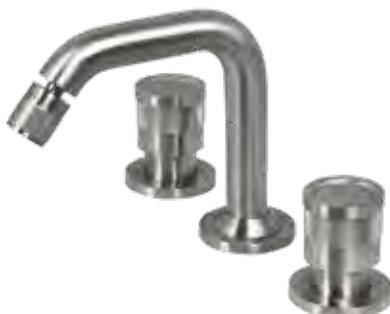
Miscelatore per bidet 3 fori in acciaio inox 316L senza scarico, dotato con bocca con snodo e aeratore anticalcare M16x1, vitone ceramico 1/4 giro e connessione G1/2".
